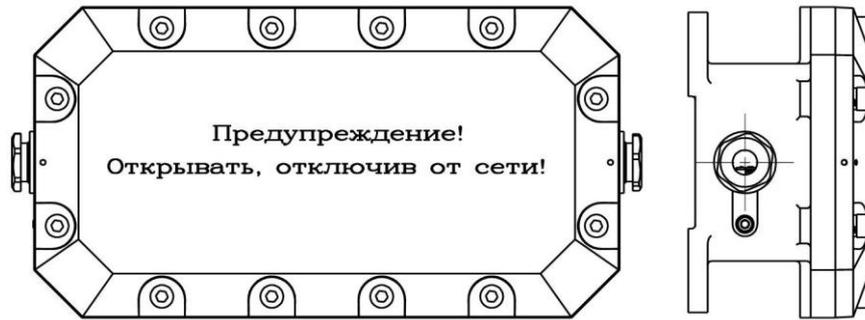
Рис. А.2. Вариант исполнения коробки модели ЕхКК-А1 с двумя кабельными вводами – ЕхКК-А1-Б(Х); Г(Х). Остальное см. Рис. А.1.
